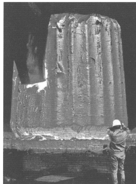
写真 2 加熱された超大型鋼塊と鍛造作業状況
