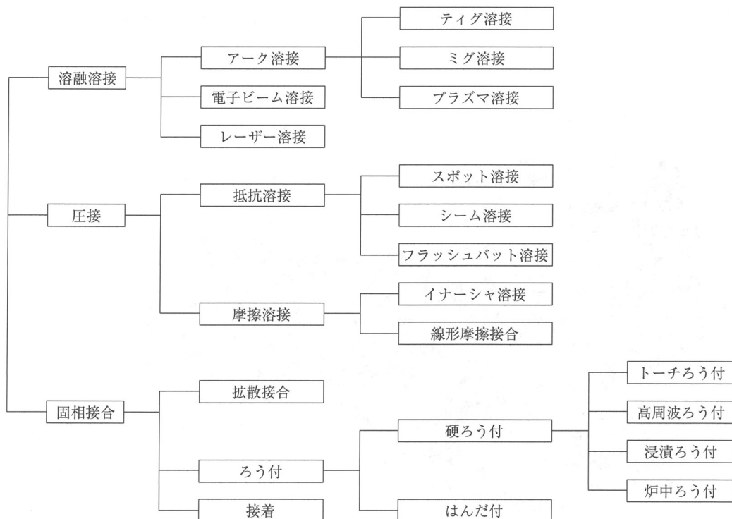
図 3 航空エンジンに適用される溶接・接合技術
