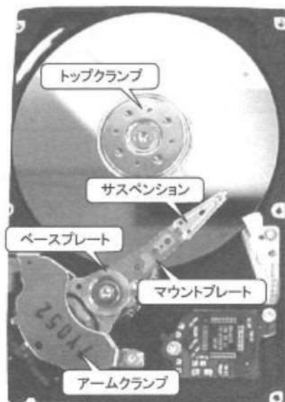
図 3 ハードディスク・ばね材適用部品
