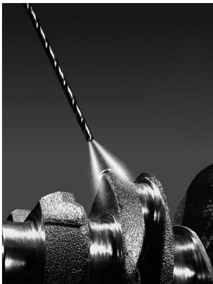
写真2 クランクシャフトの斜油穴に代表される小径深穴高能率加工事例
