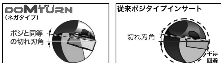
図 2 ホルダの切れ刃角の比較
