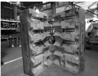
図 16 アプセッタ鍛造金型
