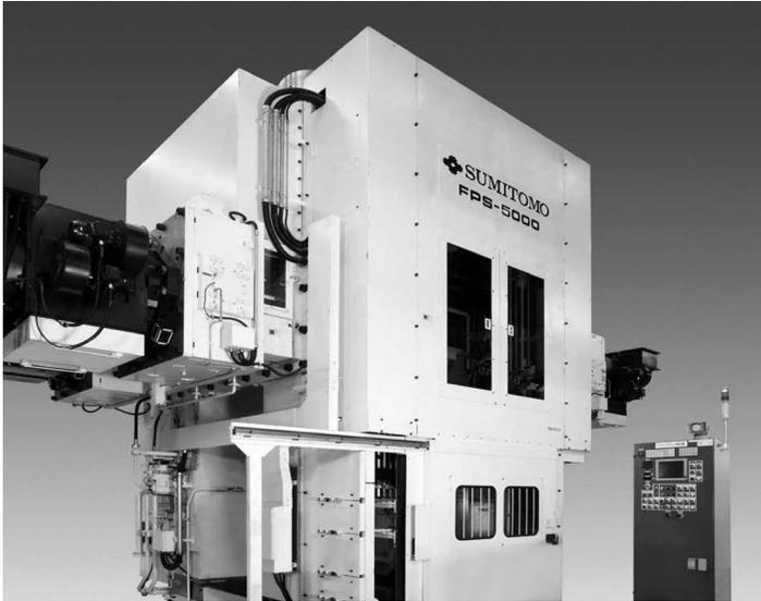
図 7 5,000t熱間鍛造サーボプレス<sup>8)</sup>
