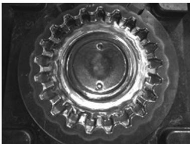
図 13 スプロケットのハンマ鍛造金型
