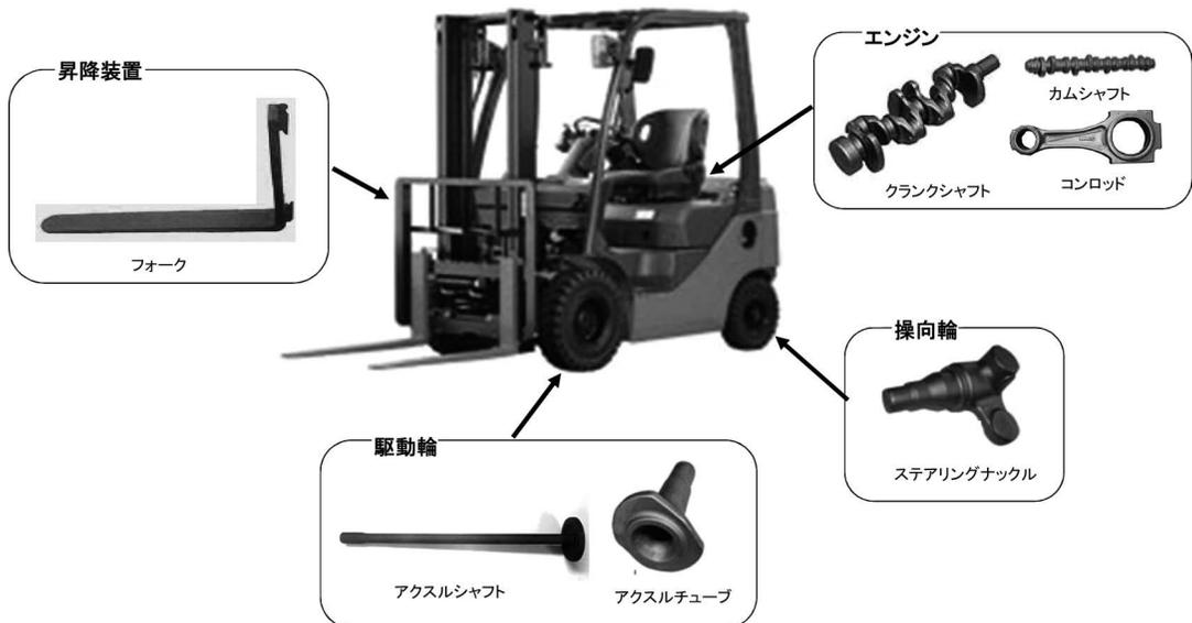
図 18 フォークリフトに使われている主な鍛造製品
