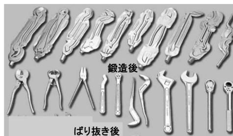
図 27 作業工具の鍛造品
