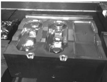
図 12 トラックリンクのハンマ鍛造金型
