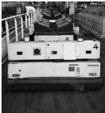
図 3 コイル輸送用AGV
