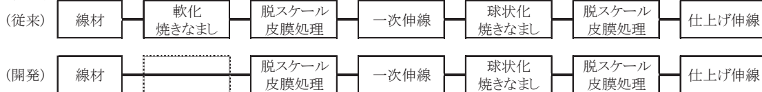
図 7 熱処理省略型の工程省略材
