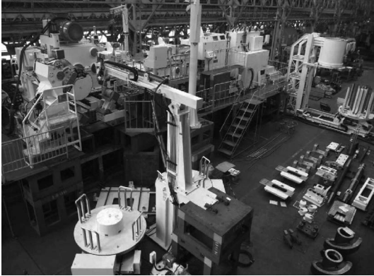
写真 2 新型巻落し式横型伸線機
