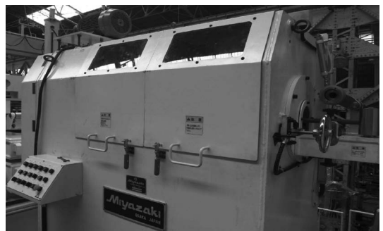
写真 4 切削バイト式先付け装置
