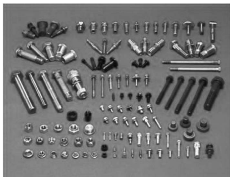
図 1 冷間圧造用鋼線より製造される各種締結部品
