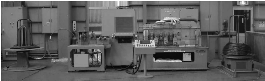
図 2 温間制御圧延装置
