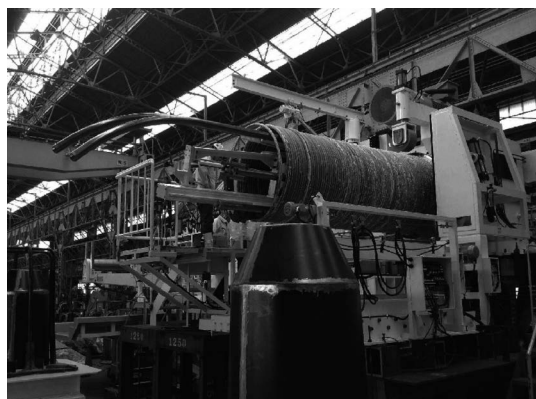
写真1 巻上げ式横型伸線機
