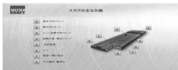
図 3 スラブ材の主要欠陥
