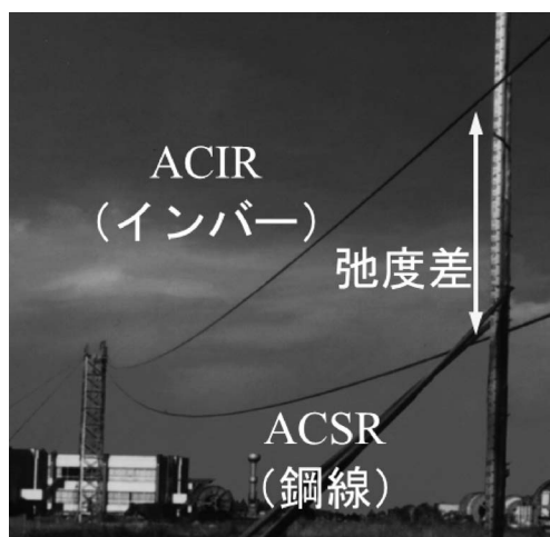
図 2 インバー電線 (ACIR) と鋼線 (ACSR) に同一電流を流した場合の弛度差 (住友電気工業・実規模試験線)
