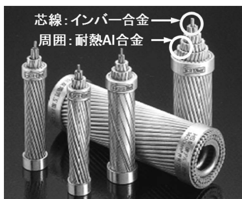
図 1 インバー合金を芯線に用いた架空送電線用インバー電線の構造 (住友電気工業・大阪製作所で製造)
