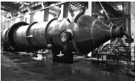
写真2 水素化流動床反応器 NAS800H
