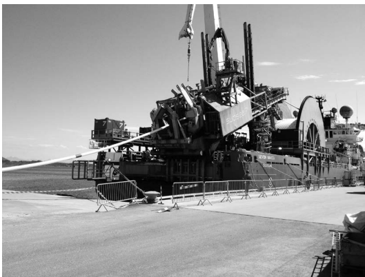
写真1 リールバージでのパイプ巻き取り
