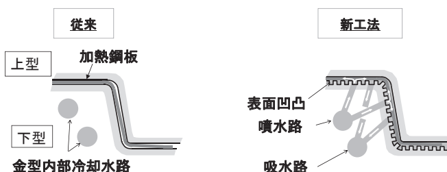
図 3 直水冷方式の金型構造
