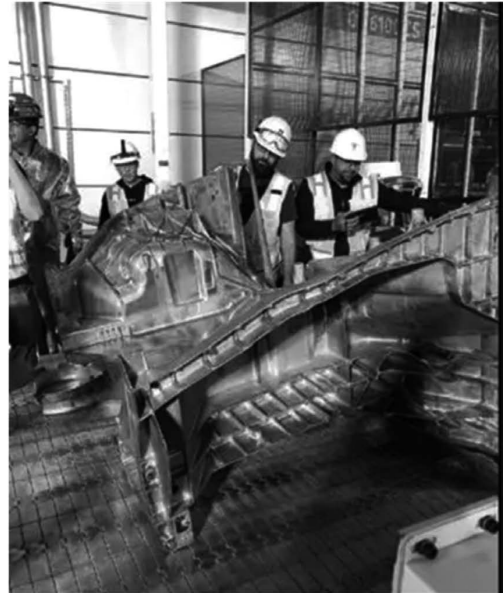
図 3 TESLA Model Y rear underbodyと製造したIDRA製GigaPressマシン
