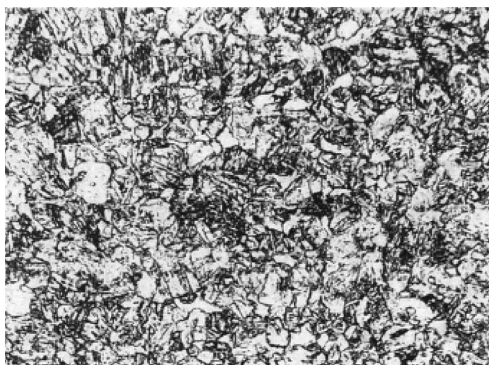
写真 1 マルテンサイト系ステンレス鋼 (SUS410) の焼入れ組織
