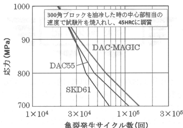
図 1 内冷孔からの腐食疲労割れ試験結果
