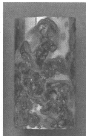
写真 1 塩水噴霧試験後の試験片外観写真 (35℃、5 % NaCl、96h)
