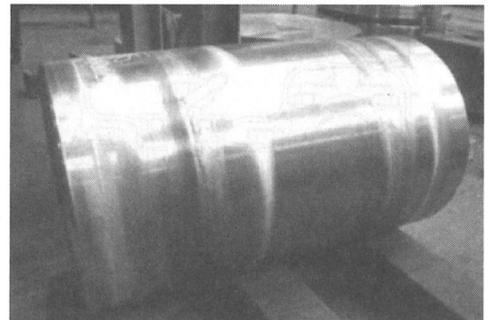
図 12 Ni基合金製ロータ (東芝提供)
