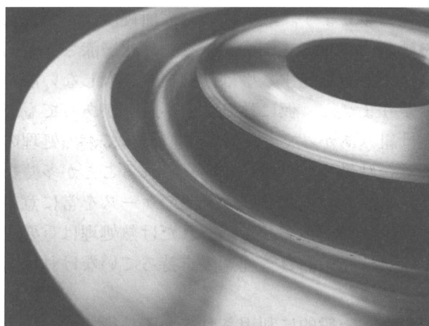
写真 2 台座軌道部レーザ焼入れ
