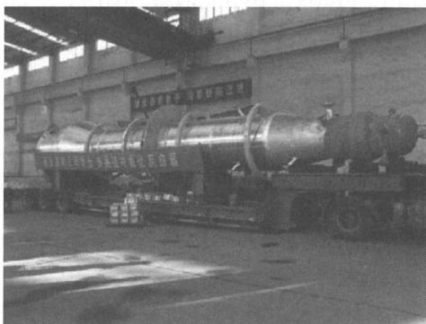
写真1 ポリシリコン製造用反応容器
