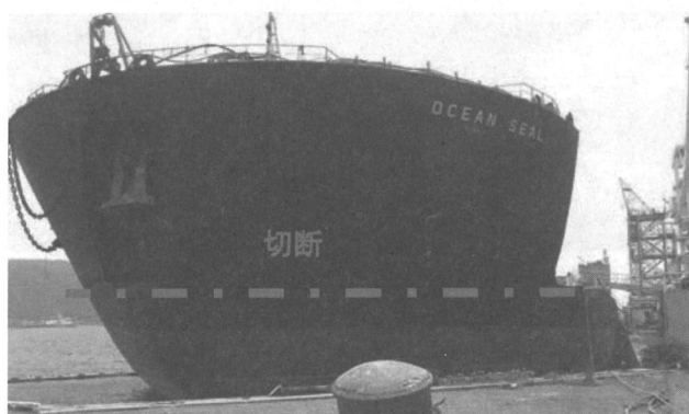
写真 8 台船改造（切断撤去）前
