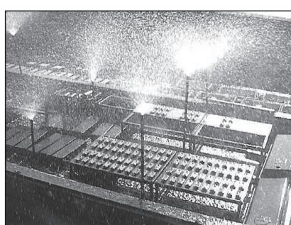
図 3 海水シャワー試験の状況と各種ステンレス鋼の10年間海水シャワー試験結果
