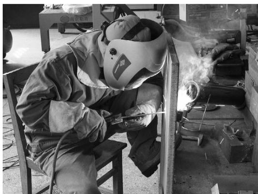
図 4 被覆アーク溶接の模式図と風景
