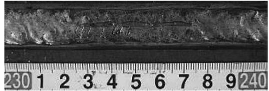
写真1 二相ステンレス鋼溶接金属のウォームホール（ガス溝）
