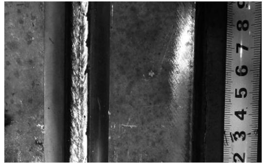
写真2 オーステナイト系ステンレス鋼溶接金属の高温割れ
