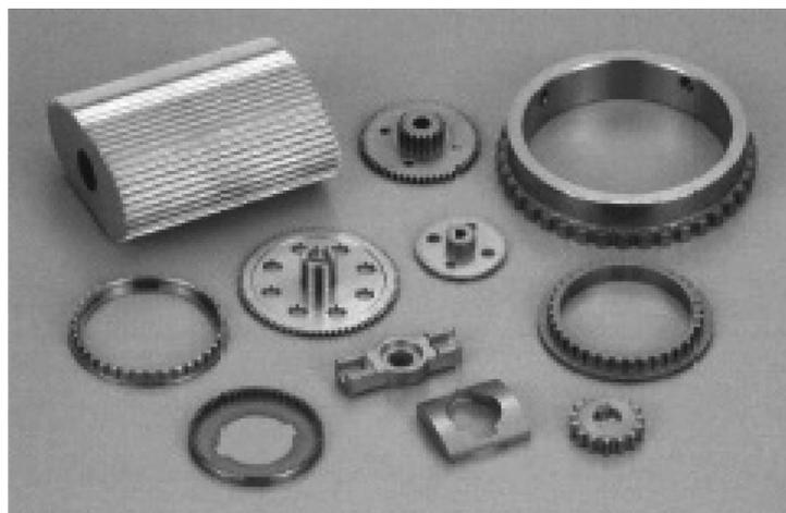
図 3 水アトマイズステンレス鋼粉末の適用例
