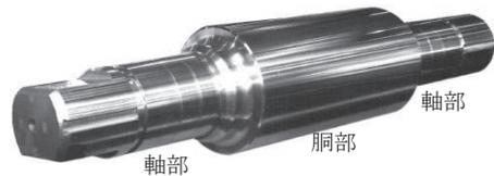
図 1 ホットストリップミル用ワークロールの外観
