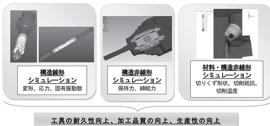
図 1 切削工具開発におけるシミュレーション
