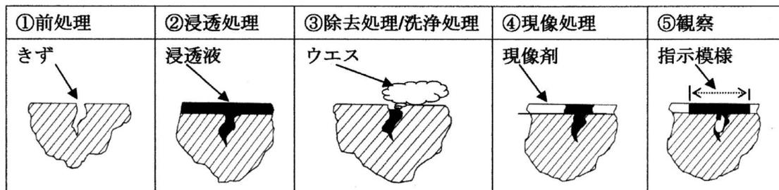
図 1 浸透探傷試験の主な手順(作業の各処理)
