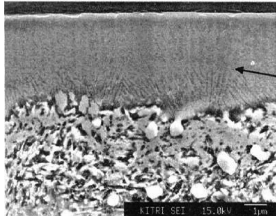
図 2 電子ビームを照射したSKD61表面（断面図）
