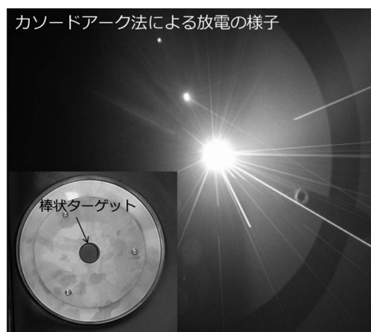
図 3 棒状炭素ターゲットを搭載したアーク蒸発源の放電の様子
