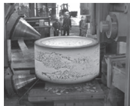
写真1 圧延力世界最大級の航空機リング成形用超大型MRB-3000リングローリングミル（圧延力1,050ton）
