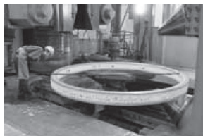
写真1 圧延力世界最大級の航空機リング成形用超大型MRB-3000リングローリングミル（圧延力1,050ton）
