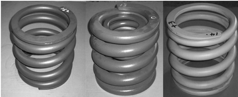
写真2 シングル、ダブル、テーパコイルばねの例
