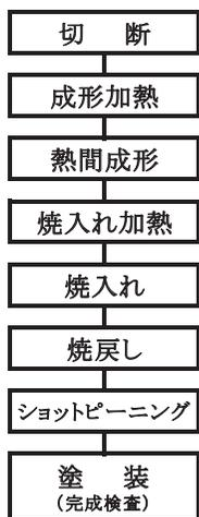
図 1 板ばねの製造工程
