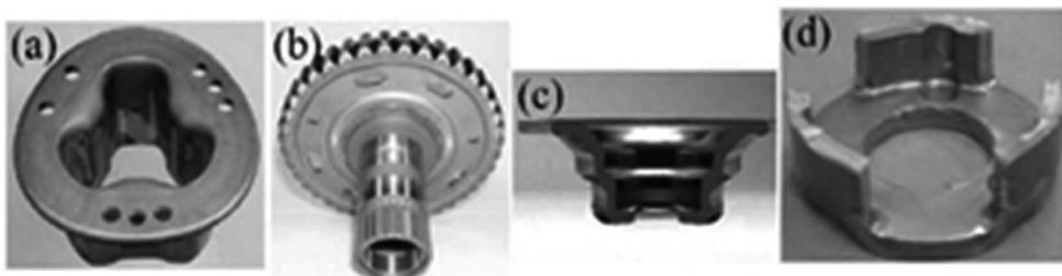
図 4 トヨタ自動車における板鍛造事例<sup>3)</sup>
