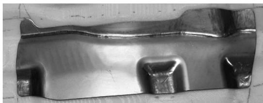
図 4 対向式ダイレス成形による成形品例
