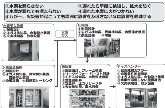
図 4 水素ステーションの安全対策
