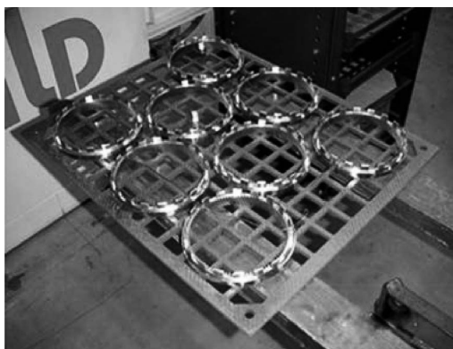
図 5 インライン型真空浸炭炉に投入される部品荷姿 9)
