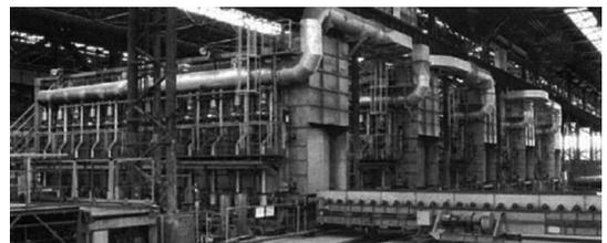
図 2 バッチ式ローラーハース設備の外観
