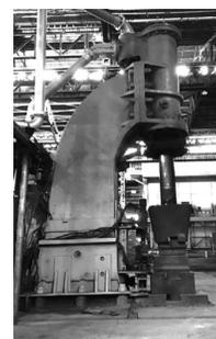
a. エアハンマー (門型フレーム) 外観 (左) と概要図 (右)
