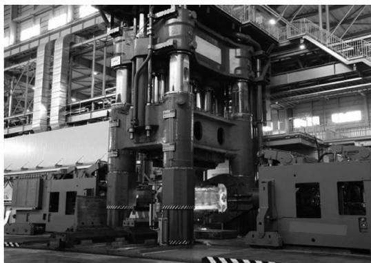
図 1 1万トン級自由鍛造プレス
