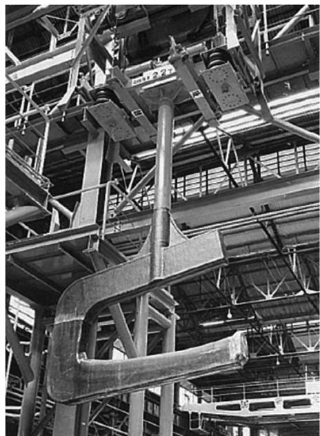
図 7 モノレールタイプ酸洗設備
