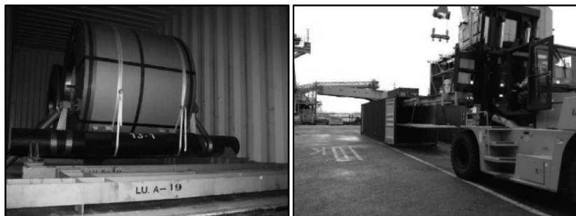
図 1 固縛方法や積み込み治具を工夫したコンテナを活用した鋼材輸送の例
