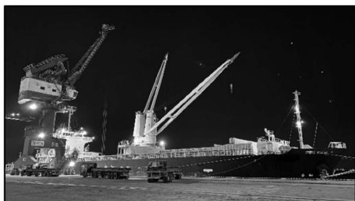
図 1 荷役設備を有する在来船の例
