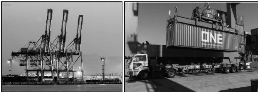
図 6 ガントリークレーン（赤いキリン）とトレーラーへのコンテナ積み込み
