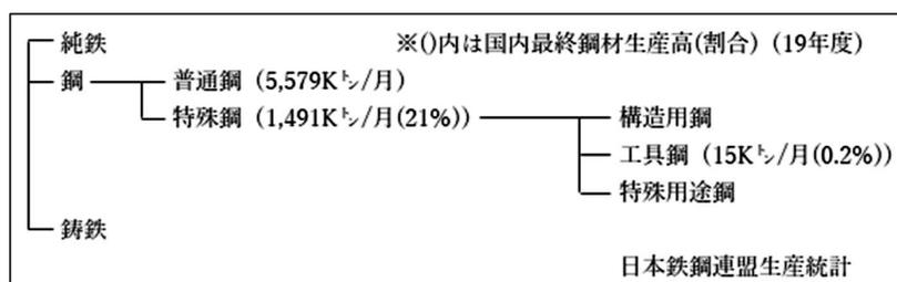
図 1 鉄鋼材料の分類
