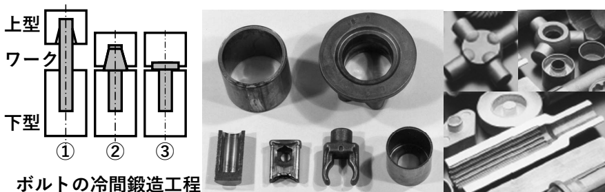
図 2 冷間鍛造品の例（単純品ボルト→複雑ギア、中空品）
