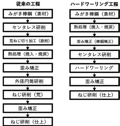
図 3 位置決め用ボールねじ製造工程
