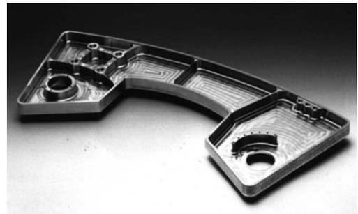
図 1(a) 航空機アルミ構造部品
