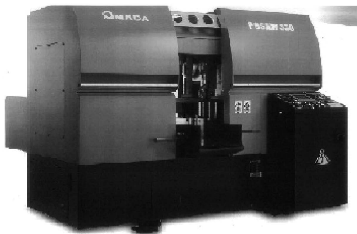
写真 1 AMADA PCSAW-330 パルスカuttingバンドソー 切断能力：丸材（径） \phi 30 \sim \phi 330 角材（幅×高さ） 30 \times 30 \sim 330 \times 330 ブレード寸法：（帯幅×帯厚×帯長）（mm） 41 \times 0.9 \times 4,115 ブレード速度：（m/min） 15 \sim 120 （インバーター無段変速）
