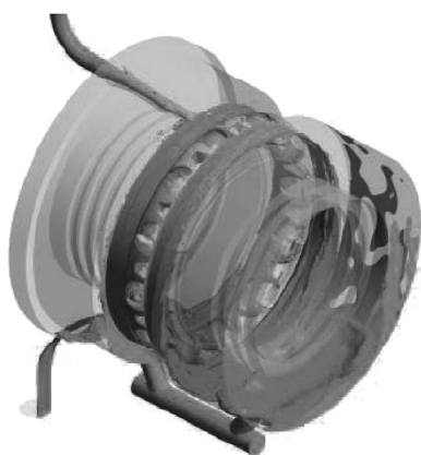
図 8-2 潤滑油流れ解析事例
