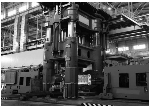
写真1 1万トン級自由鍛造プレス（1万トンプレス） 外観（株式会社プロテリアル）
