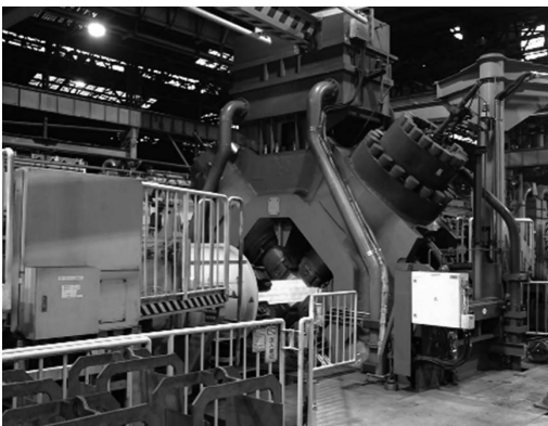
写真2 高速四面鍛造機（SMX）外観 （株式会社プロテリアル）
